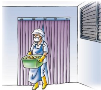
ภาพที่ 19 ติดตั้งม่านพลาสติกเพื่อป้องกันสัตว์และแมลงเข้าสู่อาคารผลิต
