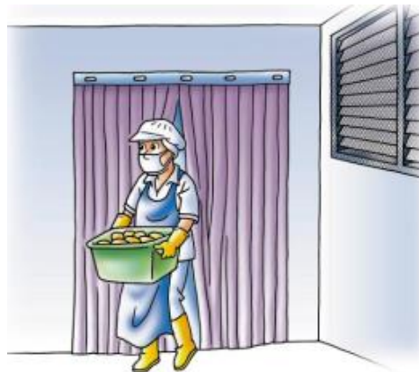
ภาพที่ 37 การติดตั้งม่านเหลืองเพื่อป้องกันสัตว์และแมลงเข้าสู่อาคารผลิต
